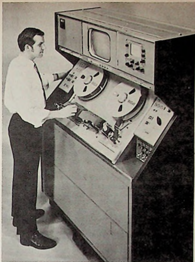
Afb. 1. De TR-70C magnetoscoop van RCA heeft een grote betrouwbaarheid dank zij de volledige transistorisering, waarmede RCA reeds in 1961 begon! Het servosysteem is in hoofdzaak uitgevoerd met geïntegreerde schakelingen. De „high-band”-recorder en de nieuwe Time Code Editing waren onderwerp van grote belangstelling op het laatste TV-symposium in Montreux.
